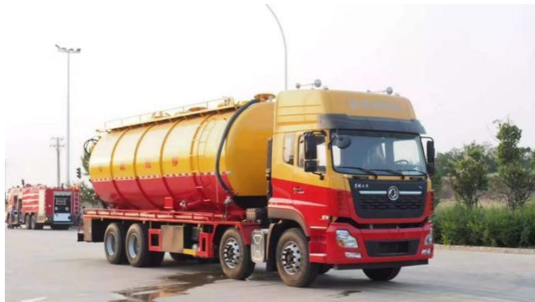
图 6.2.4-1 冲吸联合吸污车
