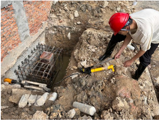
图 5.1.1-1 植筋拉拔试验示意
