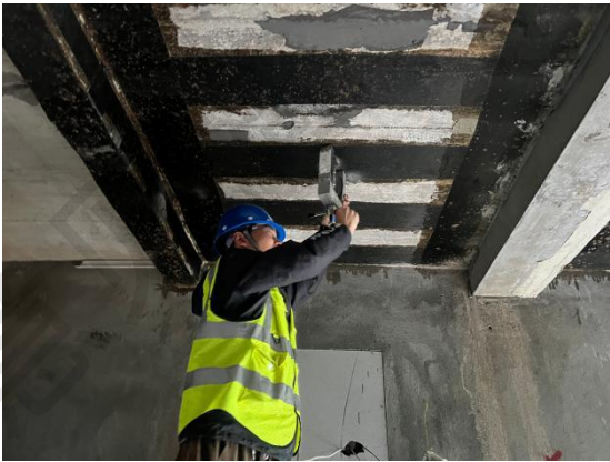
图 5.1.1-2 碳纤维片材与混凝土 粘结强度试验示意
